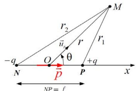
électrostatique ne dépendent donc pas de  $\varphi$ , mais seulement de  $r$  et  $\theta$ .  $M$  est alors repéré par ses coordonnées polaires  $(r, \theta)$ . On se place par ailleurs dans l'**approximation dipolaire** : cela implique que le point  $M$  est suffisamment éloigné du dipôle pour que  $\ell = NP$  soit très petit devant  $r_1$  et  $r_2$  et  $r \gg \ell$ .
